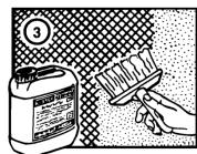
Odmah nakon ugraditi KÖSTER KD 1 te nakon 30 minuta ponovno ugraditi KÖSTER KD 1.
